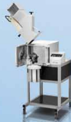
SM 300 высокопроизводительная модель с варьируемой скоростью, которая справляется даже с наиболее сложными материалами
